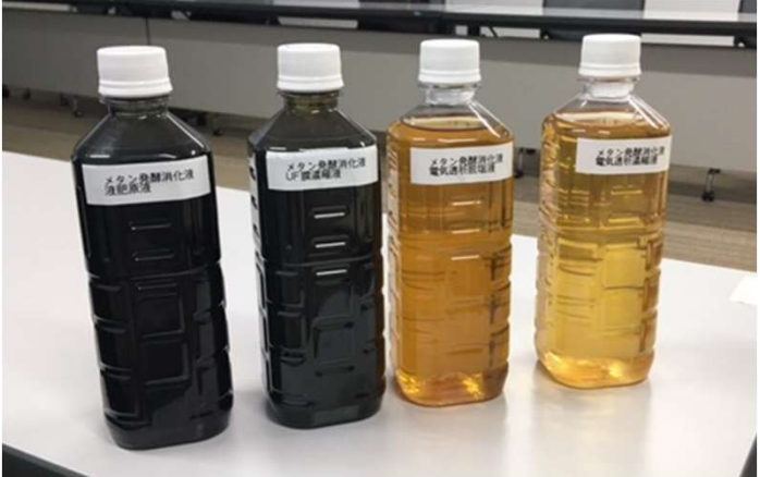
左から 液肥原液、UF膜濃縮液、脱塩液、電気透析濃縮液 (メタン発酵消化液)
