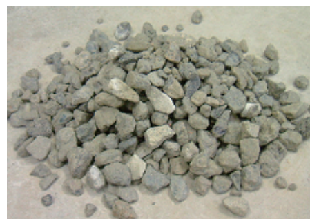
コンクリート塊から製造した再生骨材
