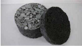
再生粗粒度アスファルト混合物(20)
