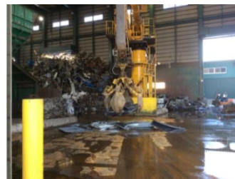
図 モジュールをシュレッダーに投入
