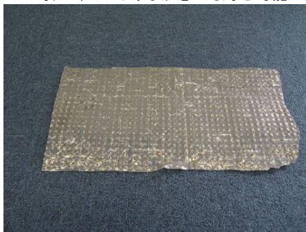
図 剥離したバックシート
