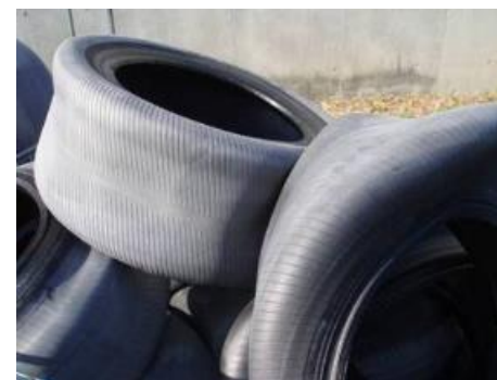
加硫の際にモールド型枠 に内圧を張る素材 (塩素含有)
