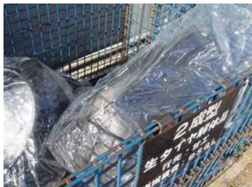
未加硫のゴム(粘着性) 一般的な破碎機・切断 機への投入不可 シート状、塊状等様々
