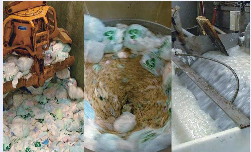
リサイクルプラントで、水と分離剤の入った分離槽へ投入し破碎、攪拌。比重差を利用してパルプとプラスチック、汚泥に分離・回収。
