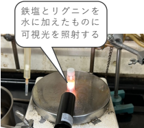
光照射実験装置にセット
