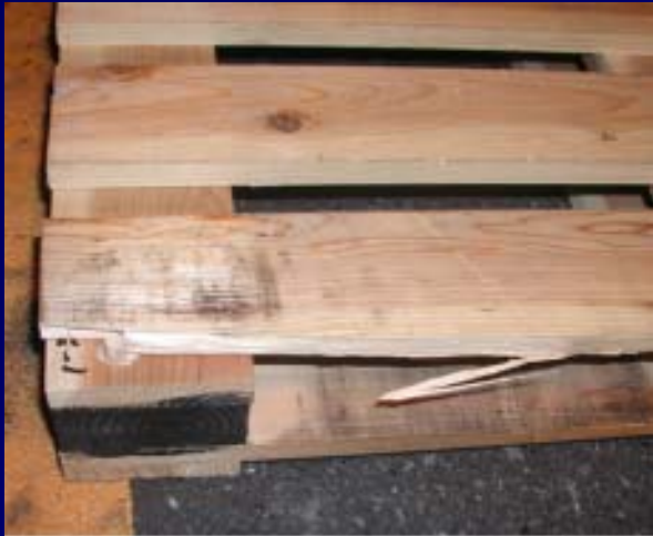
フォーク先端による エッジボードの割裂
