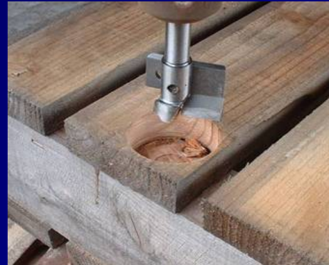
座ぐり用ドリル による取り外し
