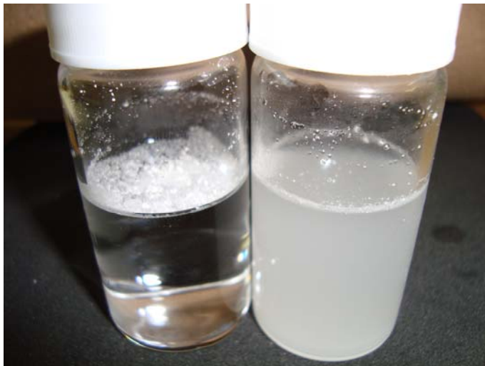
超臨界二酸化炭素により フッ素樹脂コーティングした絹粒子
