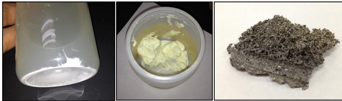
⑤ 治具剥離槽(左:沈降汚泥、中央:汚泥ろ過品、右:電解回収物)
