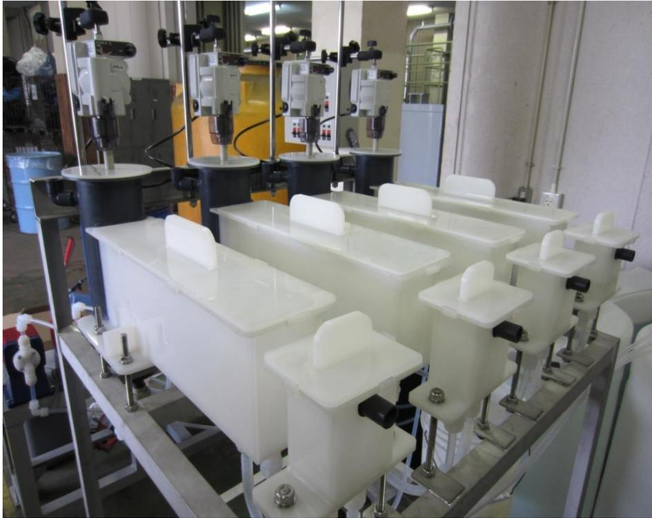
ミキサーセトラ—抽出—剥離装置
