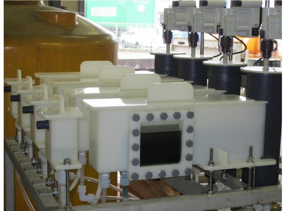
ミキサーセトラ—抽出—剥離装置(側方)
