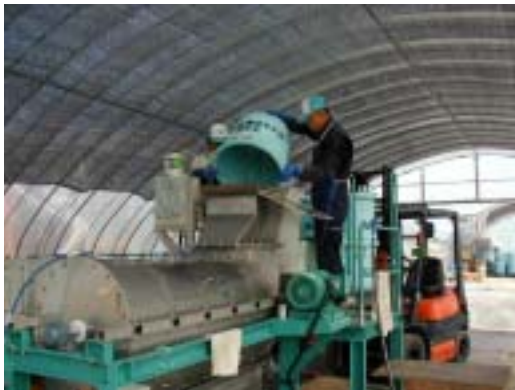
破砕分別機に生ゴミを投入
