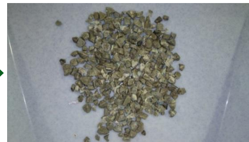
フレーク状廃プラ 含水率1%以下に乾燥
