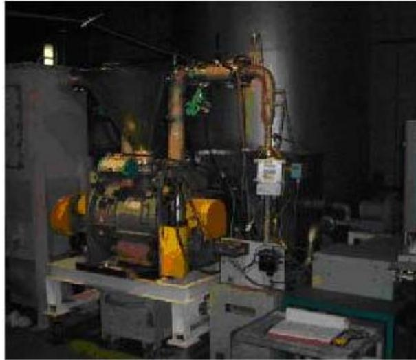
写真1 焼却灰炭酸化実証装置本体（W450cm×L250cm×H200cm，内容積約50L）
