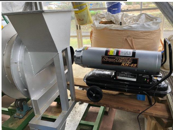
熱源は13KWのスポットヒーター
