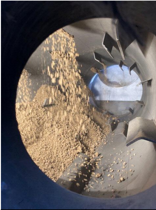
乾燥器内の廃菌床乾燥状況
