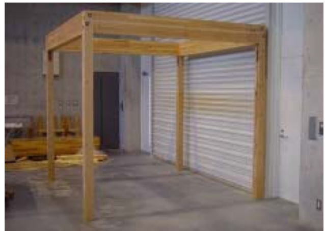
写真 1 廃棄木材で製造した集成材による柱梁
