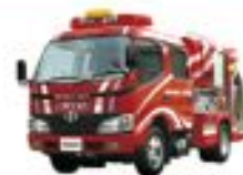
専用消防車 (圧縮空気泡消火システム)
