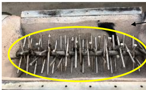
軸回転型溶融炉の内部構造
