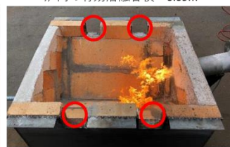
○：刺激棒を差し込む為の隙間 →手動でアルミへせん断力を与える
