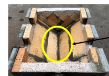
○：刺激棒を差し込む為の隙間 →手動でアルミへせん断力を与える
