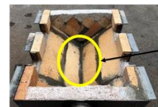
○：刺激棒を差し込む為の隙間 →手動でアルミへせん断力を与える
