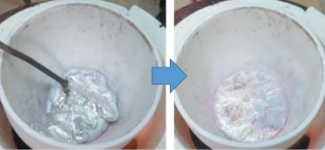
アルミラミネート箔から回収したアルミ再生塊
