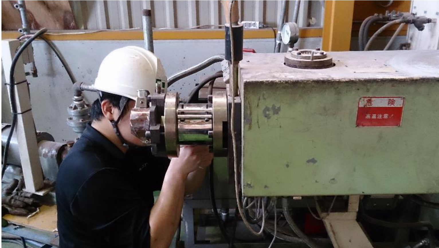
溶融樹脂溜まり部を追加した2軸押し出し機の試作
