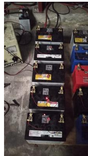
80D26L サイズ: W173 × H204 × L260 容量: 55 Ah
