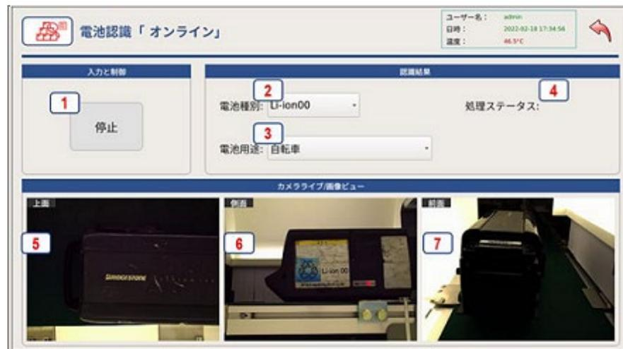
認識された種類、用途については、画像認識モニターに該当する項目と画像が瞬時に表示され、作業者が誤認識を確認することが可能
