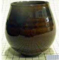
・小石原粘土の最大30%を置換可能(焼成温度1230℃)
